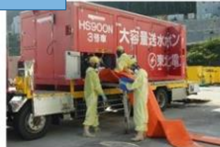
シーケンス訓練 (写真は大容量送水ポンプへのホース接続作業の様子)
