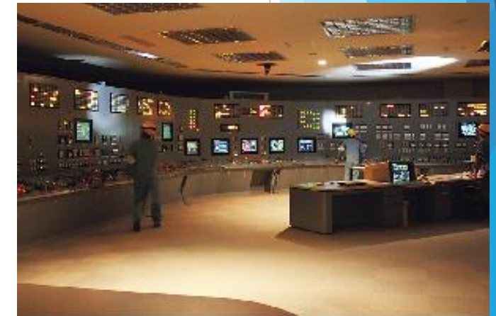
全交流電源喪失時を想定したシミュレーターによる運転訓練
